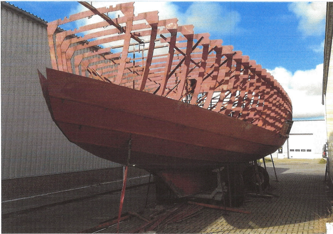
HET ROND GEJOGGELDE CASCO IS IN DE BUITENLUCHT GEBOUWD; HIER ZIJN DE ONDERSTE GANGEN GEPLAATST.
